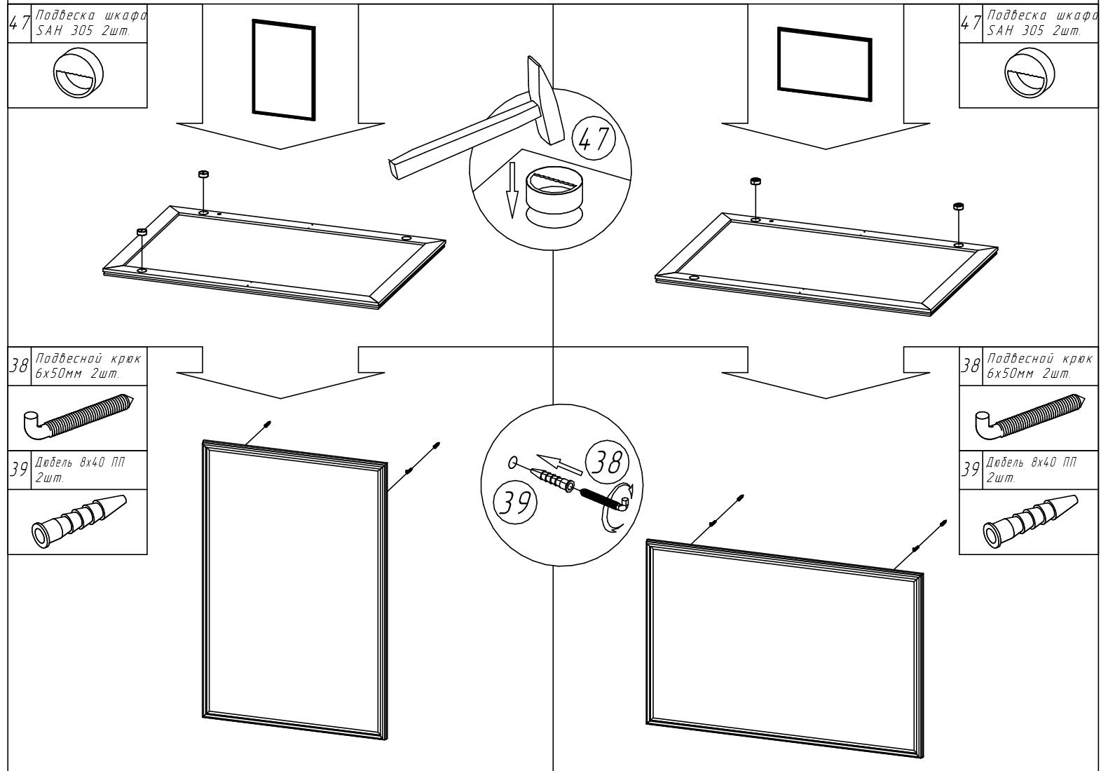
Схема разметки крепежа
