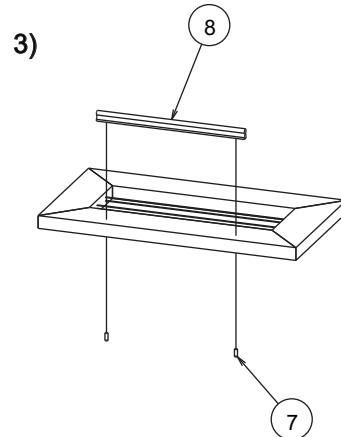
Перед установкой фасадов, определите положение ручек, и досверлите отверстия сверлом диаметром 5мм.
