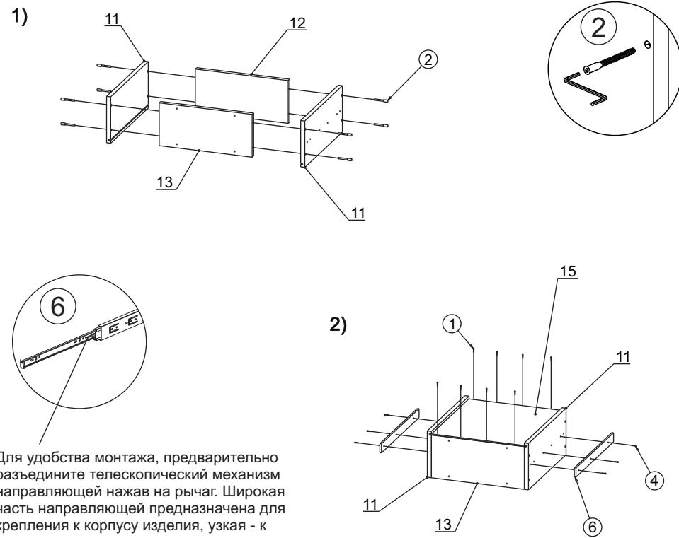
\* В случае несовпадения присадки под направляющие (позиция №6) на детали 11 и боковинах пенала, необходимо использовать существующую присадку для определения линий расположения разметки и переноса на нее отверстий (наколок), соответствующих типу направляющих, входящих в комплект поставки. Достаточно 3-х точек крепления для каждого элемента направляющей.
