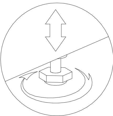
Для компенсации неровностей пола, произвести регулировку опор
