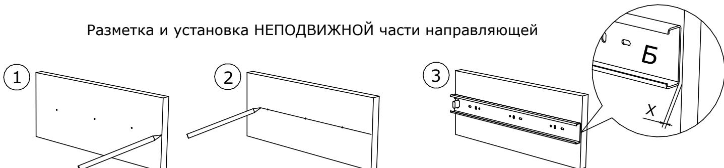
Используя любой разметочный инструмент (карандаш, маркер и пр.) необходимо провести линию через базовую разметку на деталях мебели
