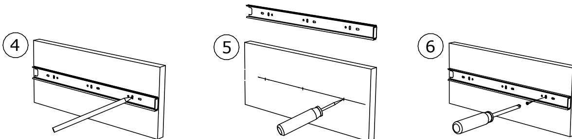
Соблюдая технологические отступы от переднего края деталей необходимо приложить элементы направляющих на линии разметки и отметить, через предусмотренные отверстия в направляющих, места их будущего крепления (достаточно 3-х точек крепления для каждого элемента выдвижной направляющей).
