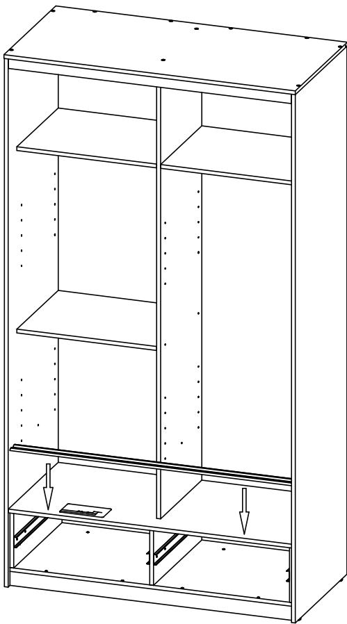
Закрепите нижнюю направляющую к детали №10 на двусторонний скотч, прикрепленный с тыльной стороны трека, на расстоянии 18мм от переднего края детали №10
