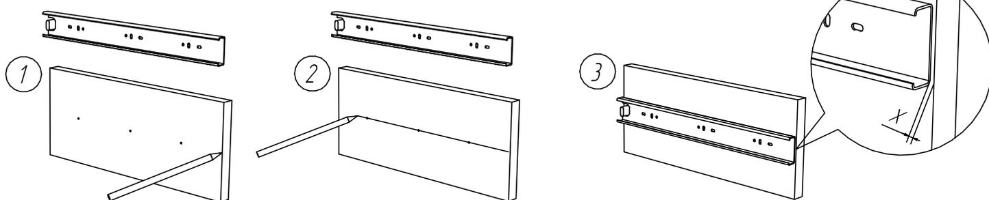
Используя любой разметочный инструмент (карандаш, маркер и пр.) необходимо провести линию через базовую разметку на деталях мебели.
