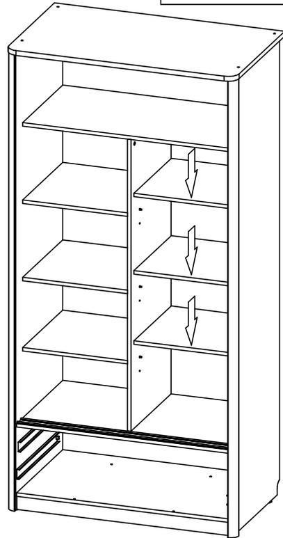
В правую секцию шкафа могут быть установлены полки или штанга
