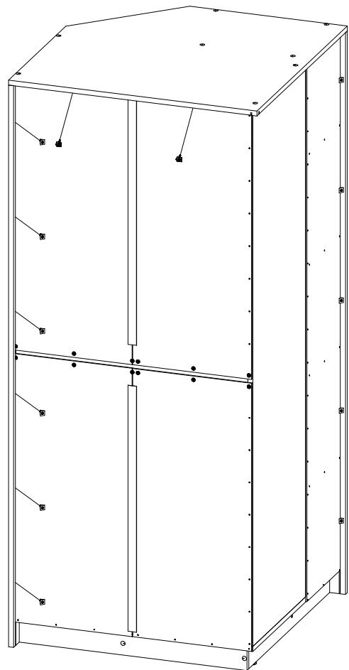
Для компенсации неровностей пола, произвести регулировку опор
