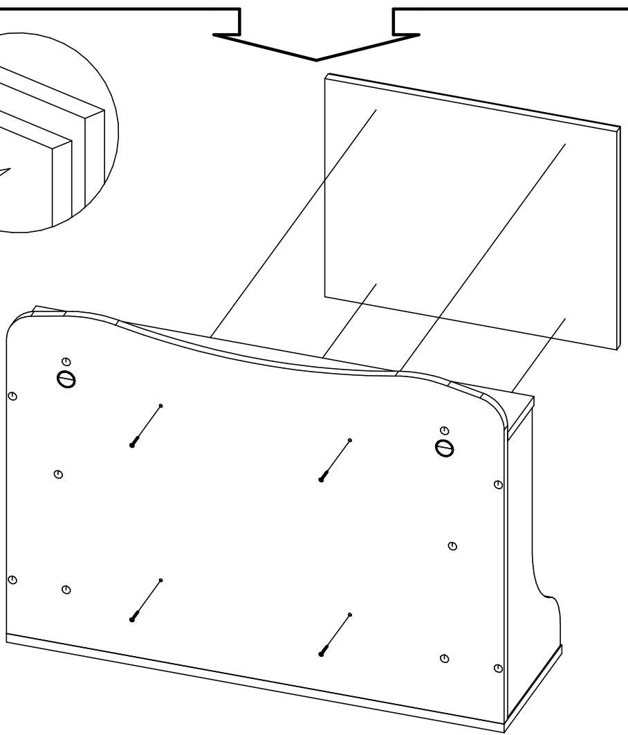
Досверлите два отверстия под настройку (диаметром 5мм) с нижней стороны крышки (деталь №1 изделия корпус комод Регата-1), предварительно подложив ненужный брускок с лицевой стороны.
