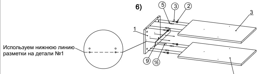
Используем нижнюю линию разметки на детали №1
