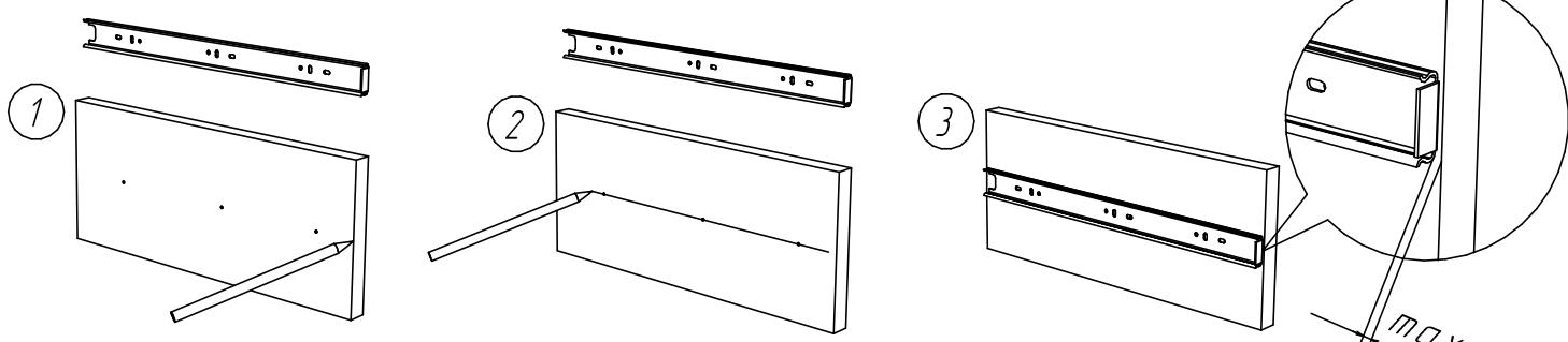
Используя любой разметочный инструмент (карандаш, маркер и пр.) необходимо провести линию через базовую разметку на деталях мебели.
