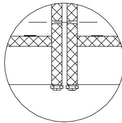
При установке изделий рядом друг с другом, необходимо просверлить отверстия диаметром 5мм в стойках изделий, подложив с обратной стороны детали ненужный деревянный брусок, и стянуть через них межсекционной стяжкой №13,14. Внимание: изделия должны быть выровнены по высоте и глубине.
