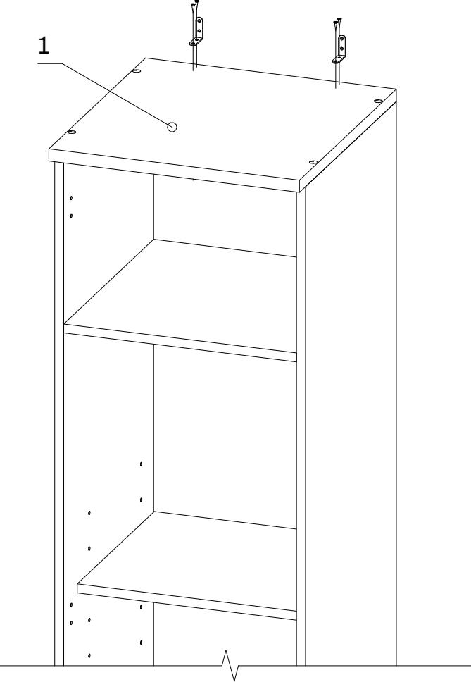
**Опрокидывание мебели может привести к серьезным или смертельным телесным повреждениям. Для предотвращения опрокидывания мебель должна быть прикреплена к стене.**
