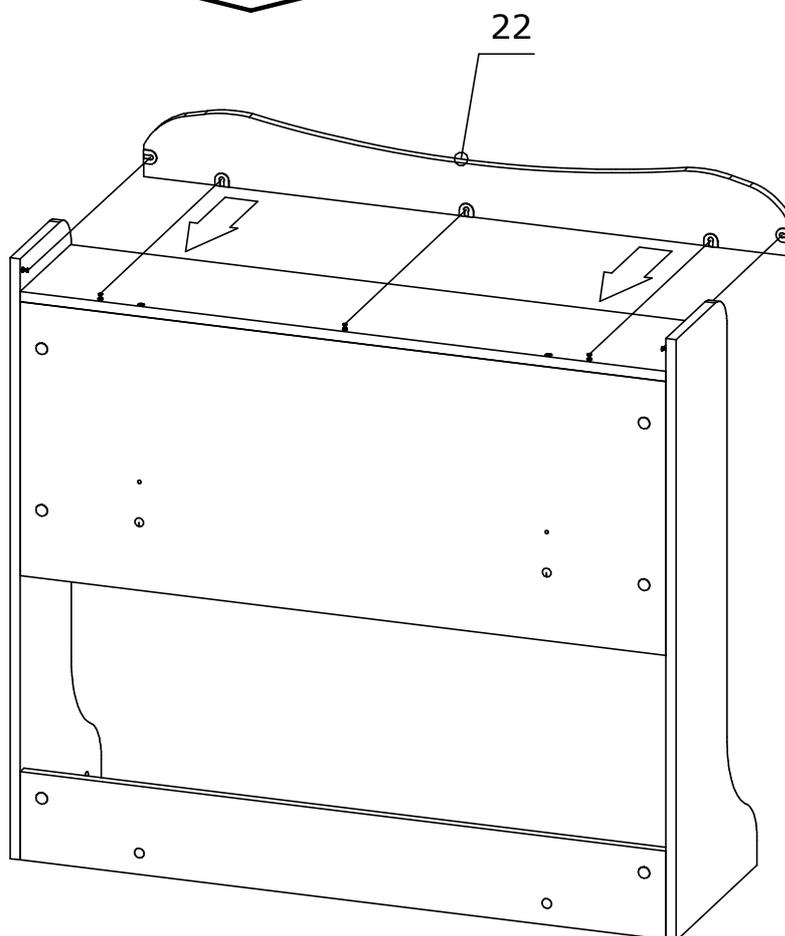
Досверлите пять отверстий под настройку (диаметром 5мм) с нижней стороны столешницы (деталь №20 изделия корпус стол письменный Марвин/Регата-2), предварительно подложив ненужный брусок с лицевой стороны.
