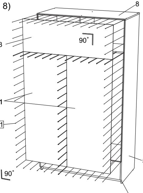
Для фиксации дверей в крайних положениях установите стопора в нижнюю направляющую до установки трека.
