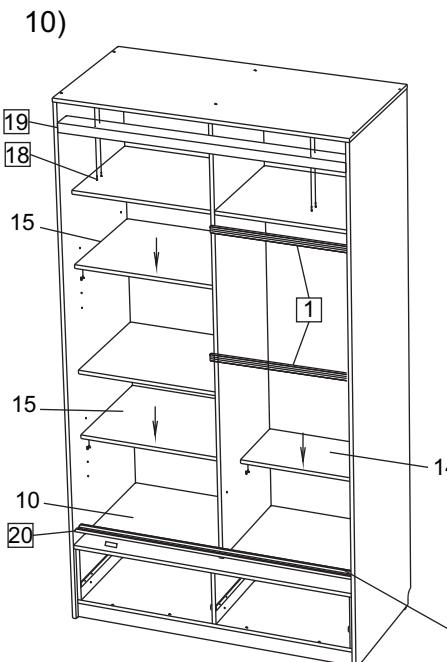
Закрепите нижнюю направляющую к детали №10 на двусторонний скотч, прикрепленный с тыльной стороны трека, на расстоянии **18ММ** от переднего края детали №10
