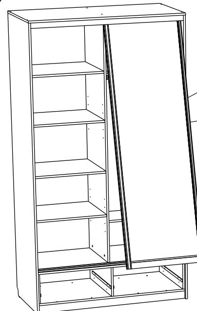
Сначала "заводим" дверь в верхний трек, под углом примерно 15 градусов, а затем в нижний трек.
