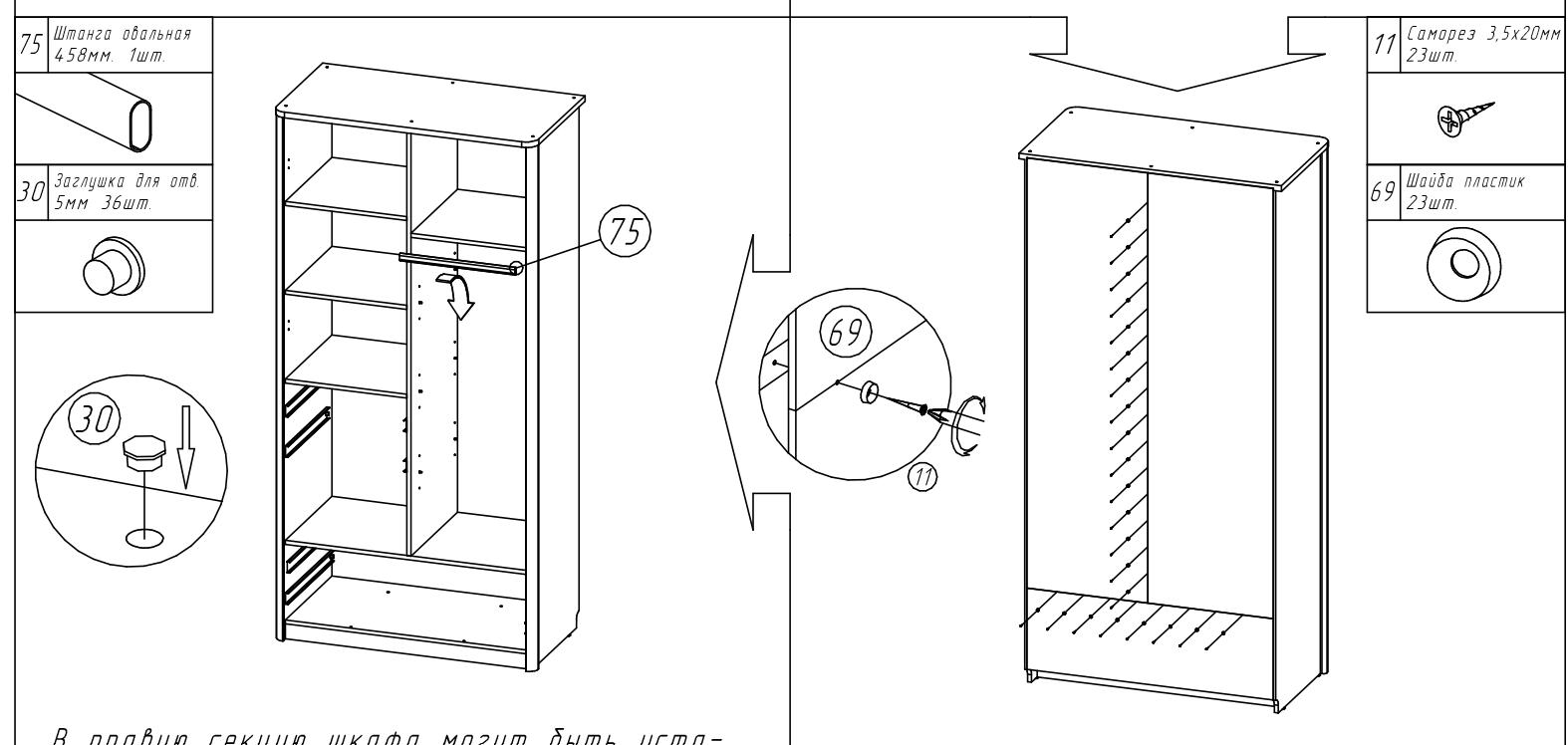
В правую секцию шкафа могут быть установлены полки или штанга
