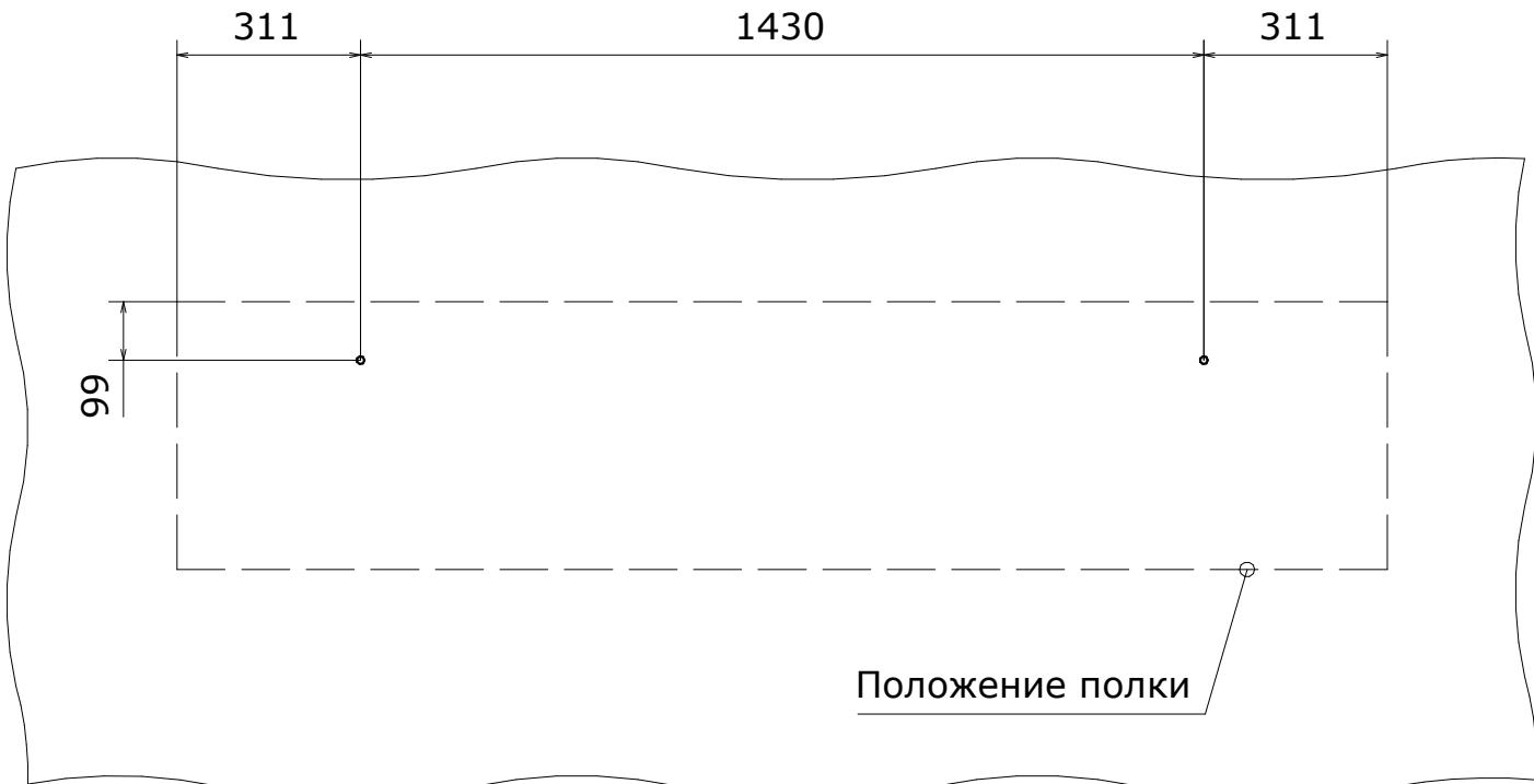
Регулировка расположения полки производится через технологические отверстия в деталях №3. Допуск регулировки 8мм
